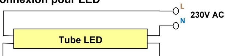
**Avec ballast ferromagnétique /électronique**
